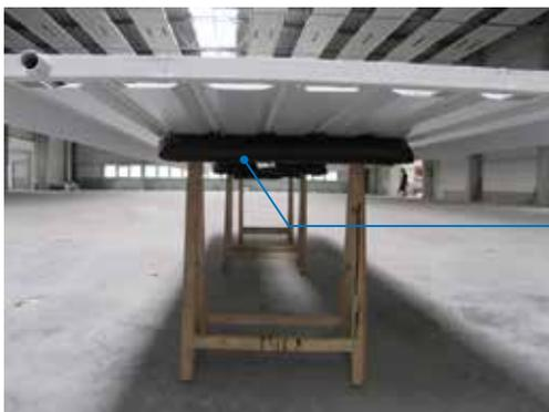
Polsterung verwenden, damit die DSP-Oberfläche nicht zerkratzt wird
