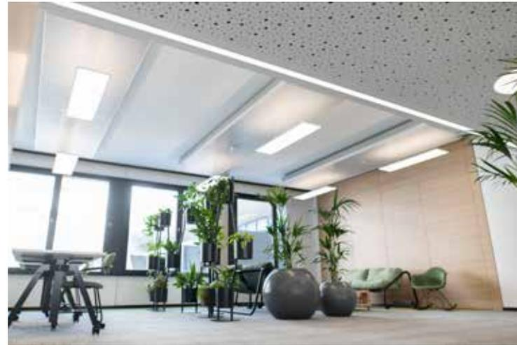
in den kleinen und großen Räumen. Und das völlig ohne Zugluft und Geräusche. Die Baulängen der montierten Segel variieren von 1,45 Meter bis 4,10 Meter. Die Baubreite beträgt jeweils 1,0 Meter. Lackiert sind die Smartline-Segel in Weiß, ähnlich RAL 9010, und hochwertig beschichtet im sogenannten Coilcoating-Verfahren. Sie sind mit einer akustisch wirksamen Perforation versehen. Ihre Lebensdauer liegt bei mindestens 30 Jahre – und das ohne jede erforderliche Wartungsmaßnahme.
