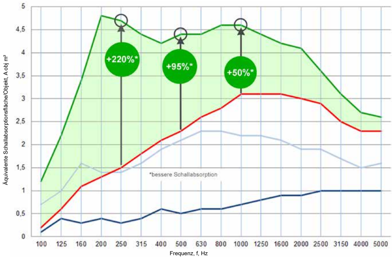
Beispielhafte Werte der äquivalenten Schallabsorptionsfläche/Objekt im Hallenraum
